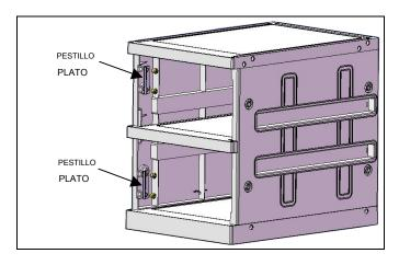
Paso 11. Instale tornillos y tapas de agujeros donde los paneles laterales se unen a los paneles superiores y al panel base. Hay 22 tornillos y tapas de orificios en cada uno de los dos lados del conjunto (44 en total).
